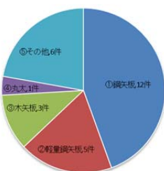
図-3 仮設防護柵に用いた横材の材質
