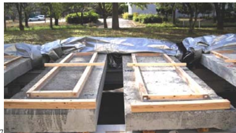
写真-2 撤去 RC 床版の水張り試験 (左 : As 舗装あり、右 : As 舗装なし)
