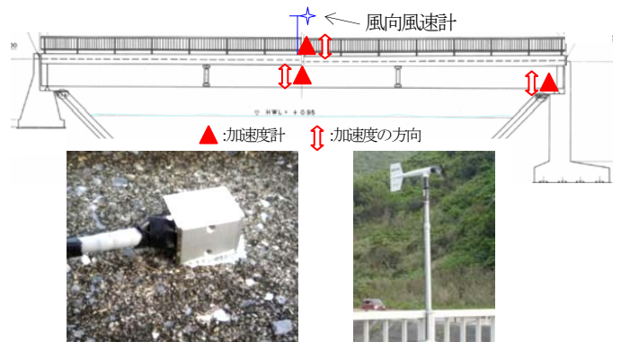
a) 加速度計測 b) 風向風速計測
