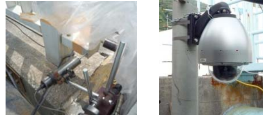
a) 変位計測 b) カメラ画像計測
