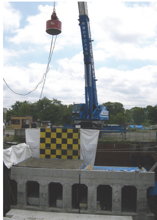
写真-5 緩衝材の有無によるロックシェッド模型の衝撃載荷実験状況
