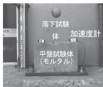
写真-1 室内実験状況（自由落下試験）
