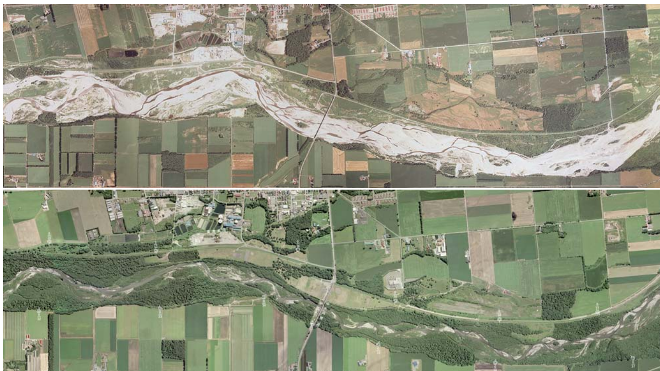
図-2 河道状況の変化（昭和53年～平成22年、戸蔦別川合流点より上流、KP0/32～0/37）
