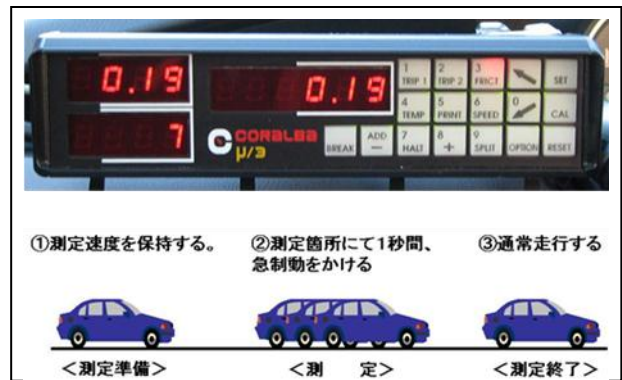
図4 加速度計（上）と測定原理（下）
