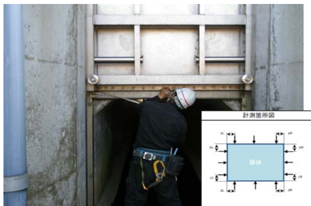
写真-9 水密ゴム硬度計測状況その1
