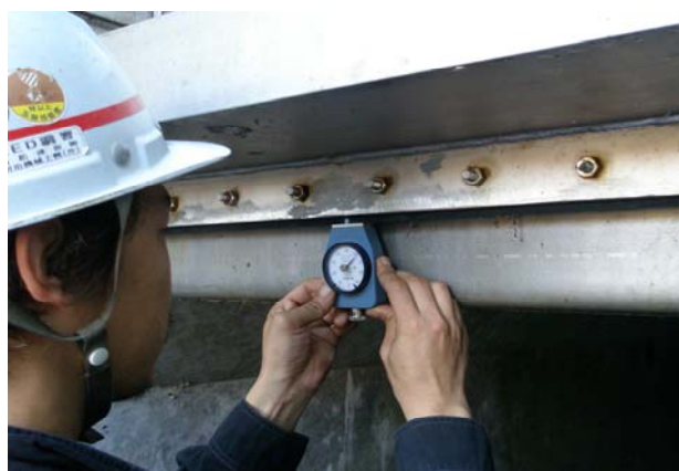
写真-10 水密ゴム硬度計測状況その2
