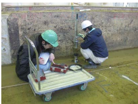
写真 - 9 小型FWD試験状況
