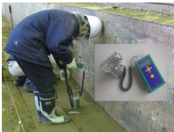
写真 - 8 超小型動的平板載荷試験装置
