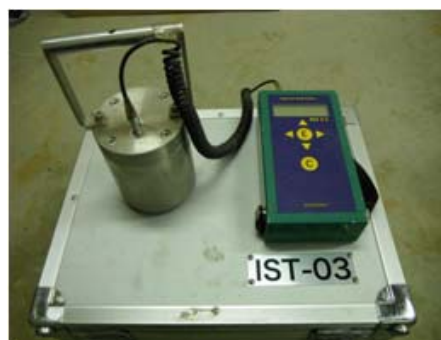
写真-6 超小型動的平板載荷試験装置
