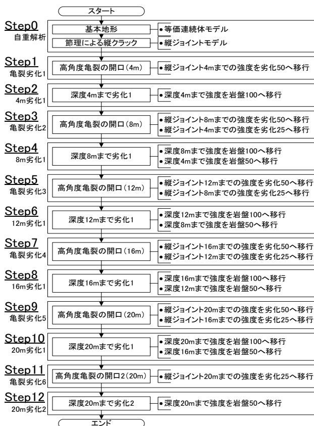
図-6 解析ステップフロー (トッピング型ゆるみ)
