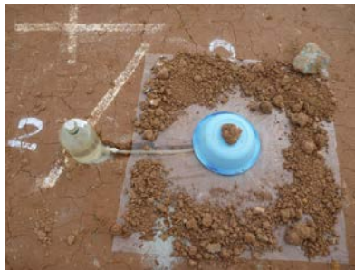
図-2.1 透水試験実施状況
