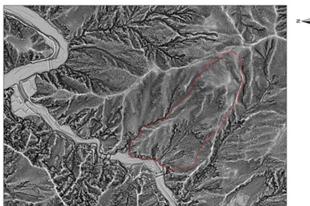
図-4 赤谷の滑動前のグリッドサイズ2mのウエブレット図
