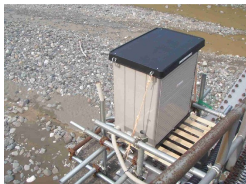
図-19 音響測深機の設置状況③
