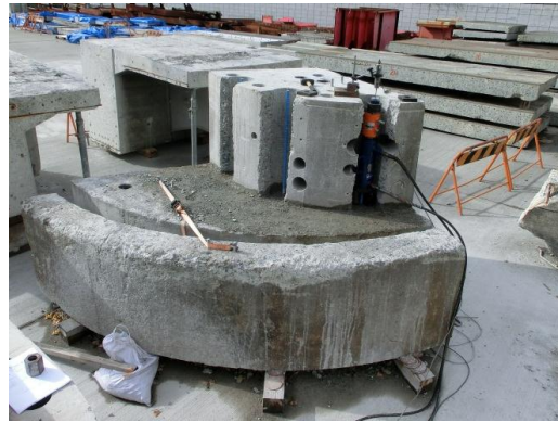
写真-13 RC巻立て軸方向鉄筋のハツリ出し状況
