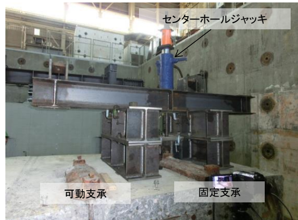
写真-10 セットアップ状況(固定支承側)
