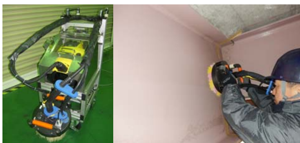
写真-1 実橋による洗浄性能確認試験 (左；プロトタイプ洗浄機、右；洗浄作業状況)
