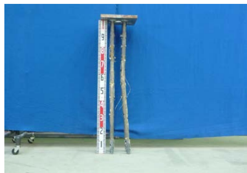
写真3 レベル2加振による杭の変形 (ケース4 未改良)
