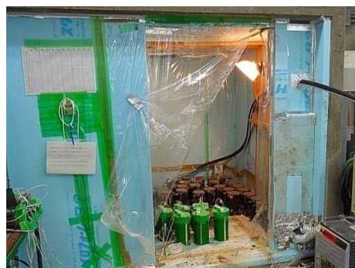
写真-4 蒸気養生室と前養生の様子
