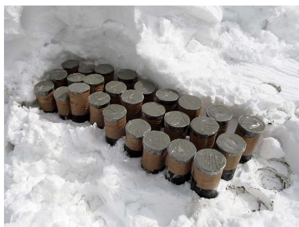
写真-3 雪中養生の状況 (養生中は雪で覆う)
