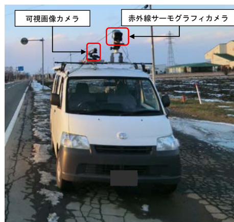
写真-1 赤外線カメラを搭載した調査車両
