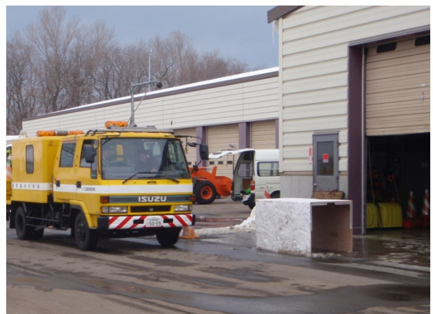
写真-2 試験状況（雪を付着させた模擬堆雪での精度試験）
