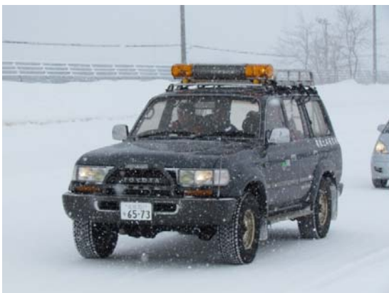
写真-9 簡易型 IRI 測定装置搭載車
