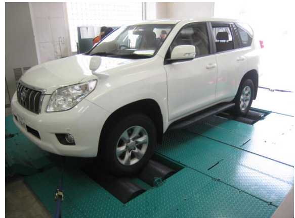
写真-3 シャシダイナモメータでの試験状況
