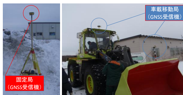
図-13 RTK-GNSS設置状況
