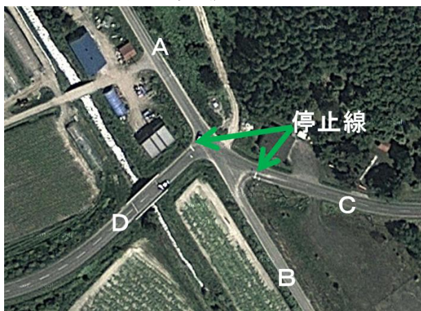
図-3 調査対象交差点(美瑛町) ※A~Dは交通量等の観測断面を示す
