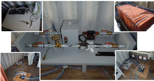
写真-3 採熱孔循環回路
