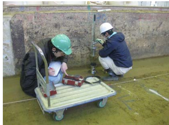
写真-9 小型 FWD 試験状況
