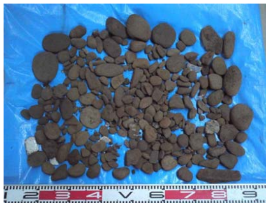
図-39 排砂口から排出された礫
