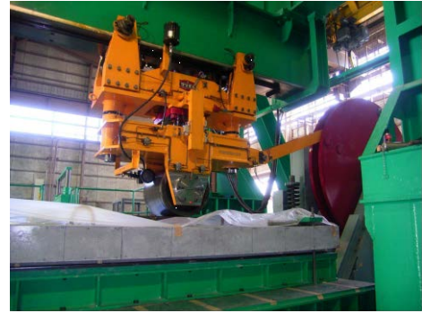
写真-3 輪荷重走行試験機
