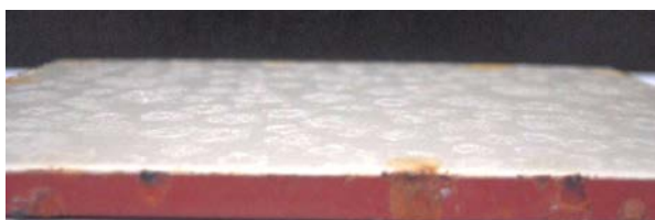
写真-4 塩付着試験片の表面凹凸
