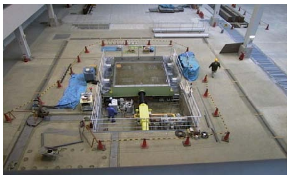
写真2 振動台実験装置
