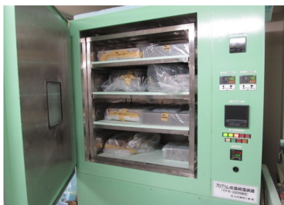
写真-2 低温恒温装置による-5℃養生の状況
