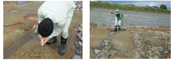
図-4 岩床の強度および凹凸高さの計測状況
