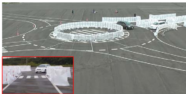
図-4 堆雪の影響に関する試験状況（夏期試験）
