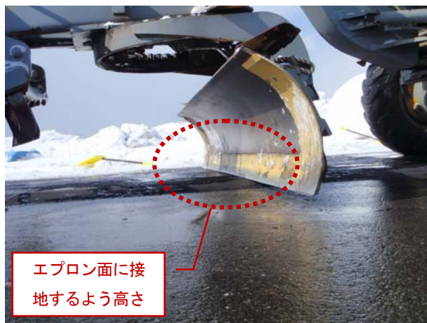
図-12 ブレードの接地状況（除雪グレーダ）
