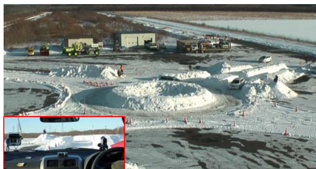
図-5 堆雪の影響に関する試験状況（冬期試験）
