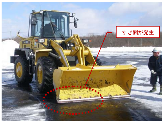
図-10 バケットの接地状況（除雪ドーザ）
