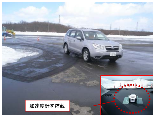
図-14 エプロン乗り上げ時の加速度の計測
