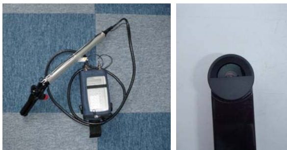
写真 - 2 プラントキャノピーアナライザー (PCA) (右/PCA 本体、左/センサー部 (180° ビューキャップ))
