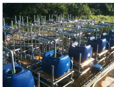
写真2. 実験に用いた高流速対応の循環型管路。
