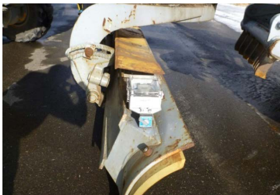
写真9 加速度計の取付状況 (モータグレーダ)
