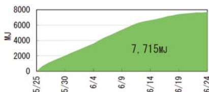
図-6 H24 実験雪山A(全空気式)の取得冷熱エネルギー量
