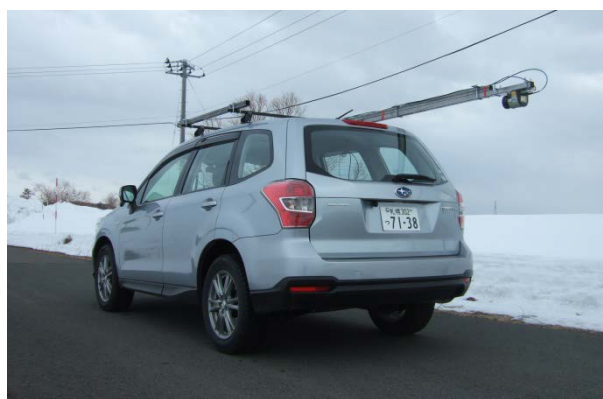
写真4 レーザーキャナを車両後方設置した計測試験状況（石狩吹雪実験場）
