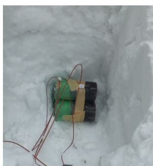
写真-3 雪中養生状況 (養生中は雪で覆う)
