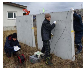
写真-2 超音波伝搬速度測定状況
