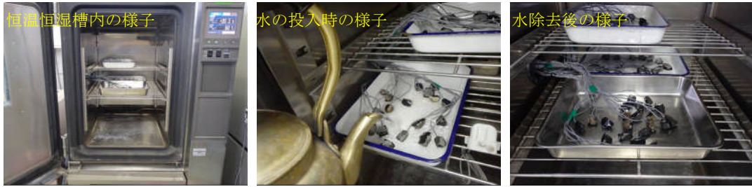
写真 13.2 乾燥収縮率試験組（恒温恒湿槽への設置状況）
