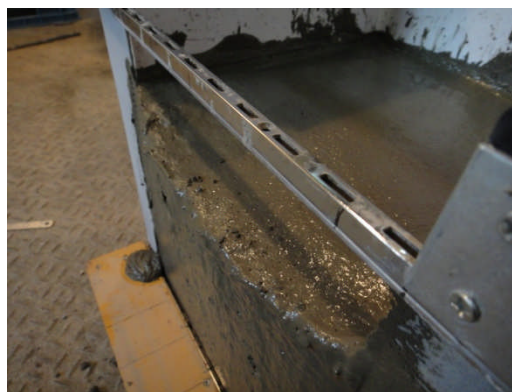
写真 6.2 エッジスランプ, オーバーフローの状況
