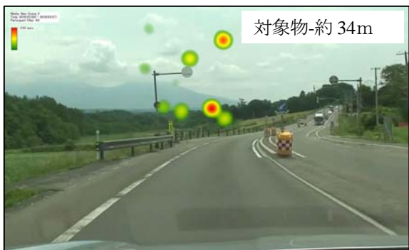
写真-12 ランドマーク視軸上で注視される張出式 識と注視されないクッションドラム (注視は約 50m 手前がピーク)
