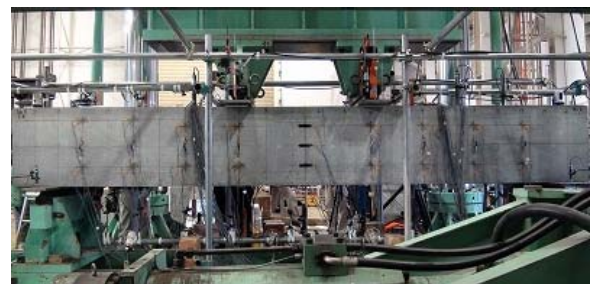
図-2.3 荷重試験機（供試体据付け状況）
