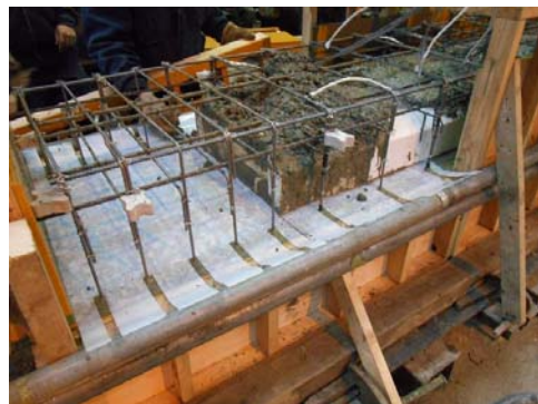
図-2.2 模擬ひび割れ導入状況
