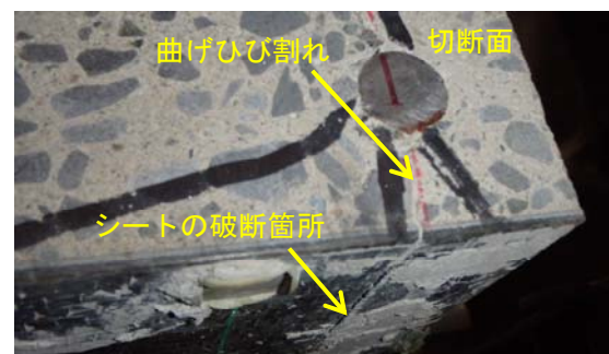
写真-4 CF1のシート破断(図-2中①)
