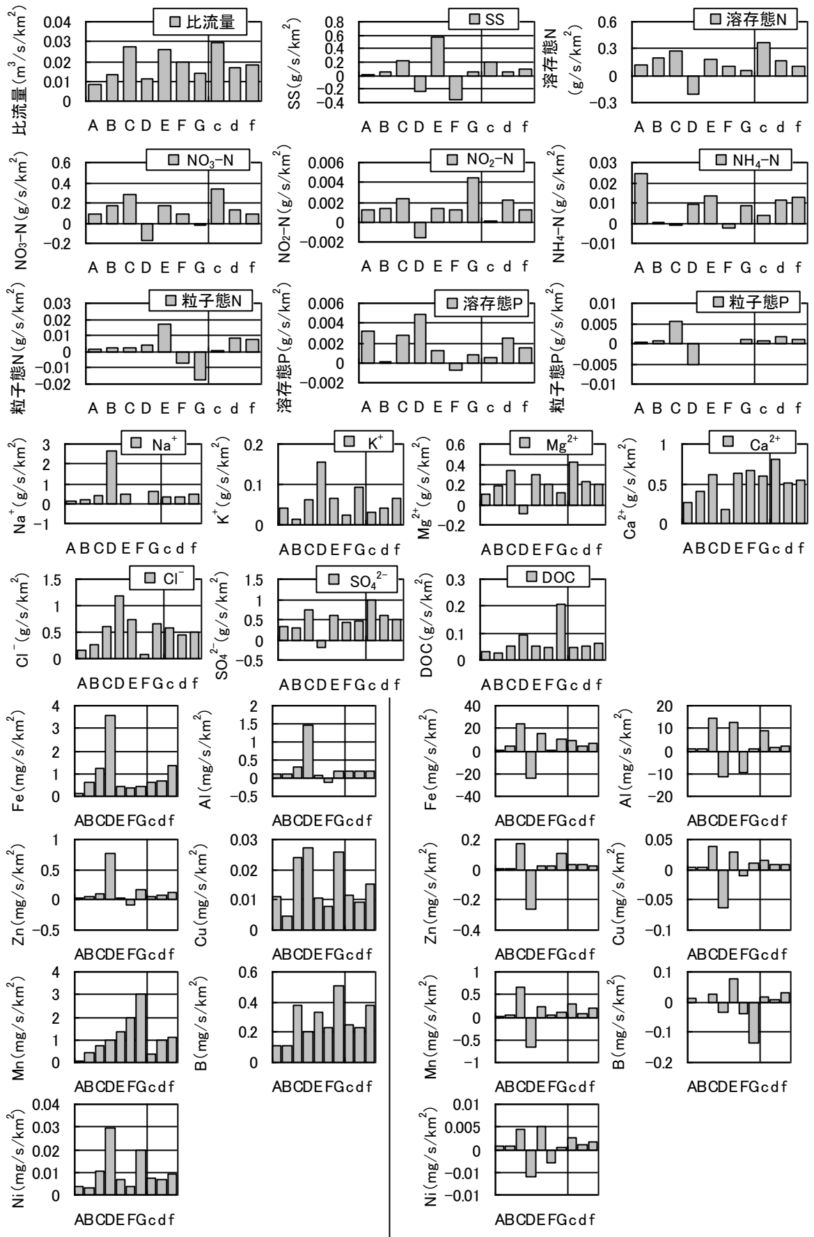
図-21 小流域（区間）別に求めた、比流量と、各水質成分の比負荷量
