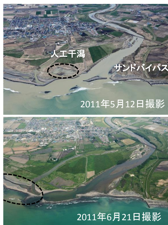
図-7 鵜川河口における融雪出水前後の地形変化 (空中写真: 寒冷沿岸域チーム 撮影・提供)
