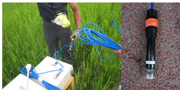
写真-4 Ehメータの設置状況とセンサー
