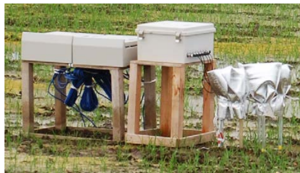
写真-3 テンシオメータ設置状況
