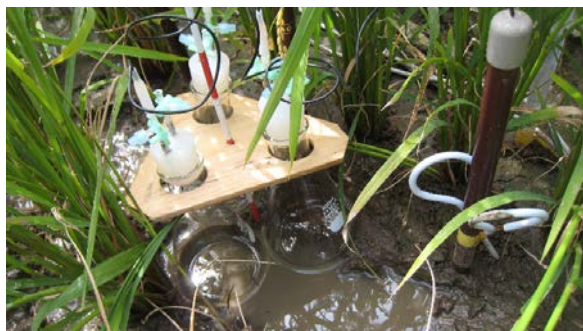
写真-5 土中水採取状況
