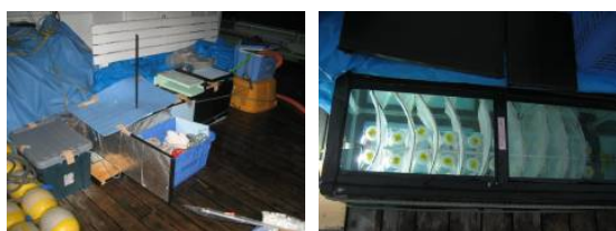
写真-1 培養水槽の設置状況(武蔵堆, 船上) 4)
