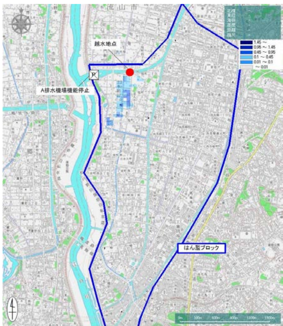
図-28 はん濫計算結果 (検サ-スH16①-1-4 V水門開時)
