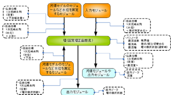
図-22 堰要素モデル接続概念図
