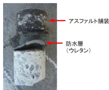
(b) 削孔中に分離したコアの側面 (T1-L5)
