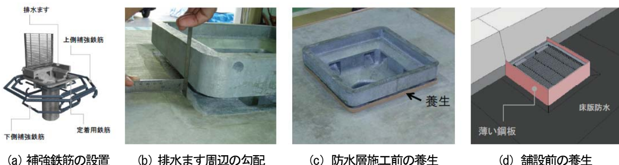
図-41 排水ます交換施工時の留意事項
