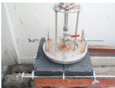
写真-2.5 カッターひび割れに対する現場透水量試験結果
