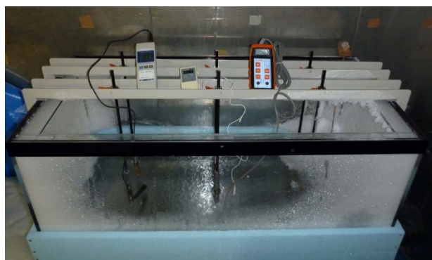
図-35 温度差腐食試験に用いた実験装置の概要図
