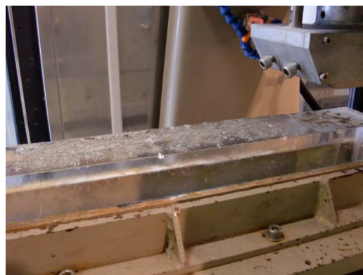
図-15 氷の表面に砂をセットした状態
