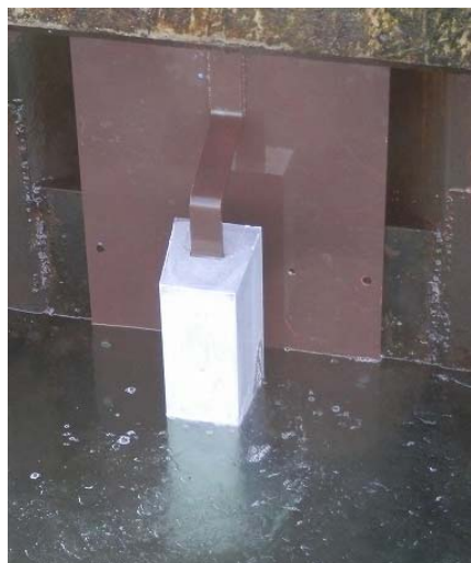
図-52 AL 陽極試験体の設置状態の例
