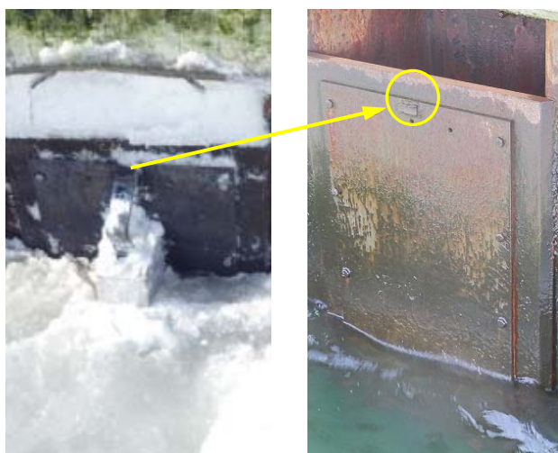
図-53(a) 試験中・試験後のAL陽極試験体の状態例 (2012年試験)
