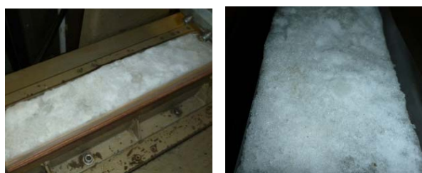
図-23 自然状態の表面部を有する自然海水の試験体
