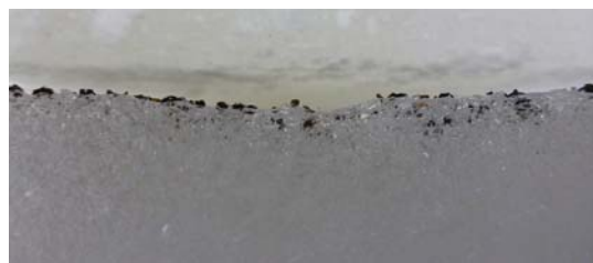
図-8(b) 試験体の縦断面の例(日陰、 0.05\text{g}/\text{cm}^2 )
