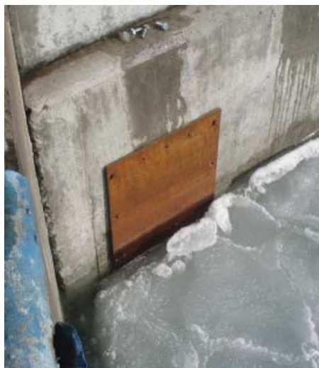
図-47(a) 網走港での暴露試験状況
