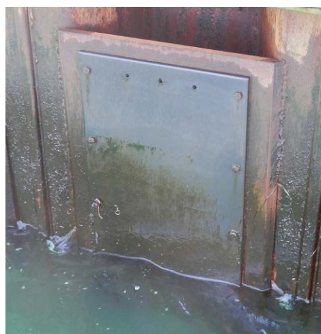
図-54 試験中の重防食試験体 (2000 \mu ウレタンエラストマー)
