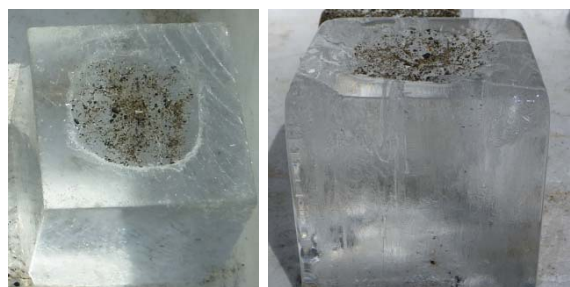
図-5 試験氷表面への砂散布直後(左)と暴露60分後の状況
