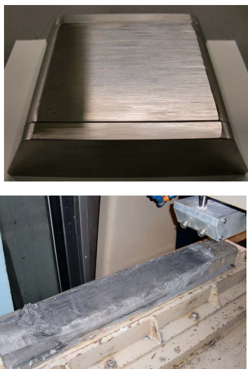
図-16 実験直後 (摩擦距離 50km) の金属供試体 (上) と氷 (下) の表面状態の例
