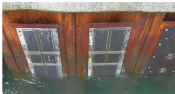
図-57 試験体の設置状況（暴露直後）
