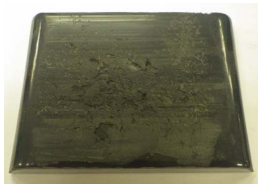
図-33 (a) 重防食被覆試験体の表面の損傷状態（凝着）（摩擦距離 50km）
