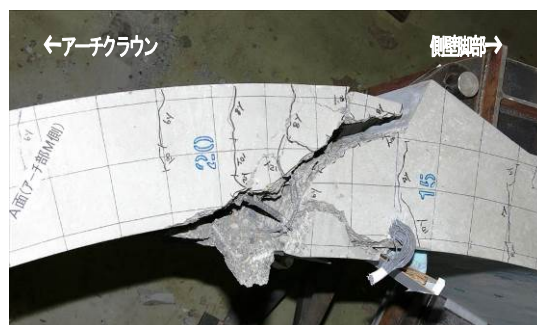
(b) アーチ肩部での曲げせん断破壊
