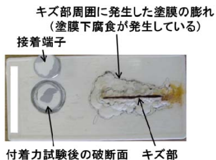
図-3 複合サイクル腐食試験における評価方法の一例
