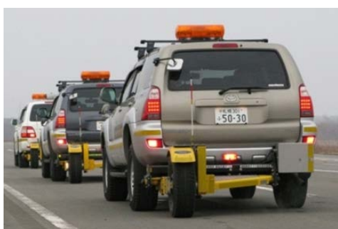
写真1 連続路面すべり抵抗値測定装置 (CFT)
